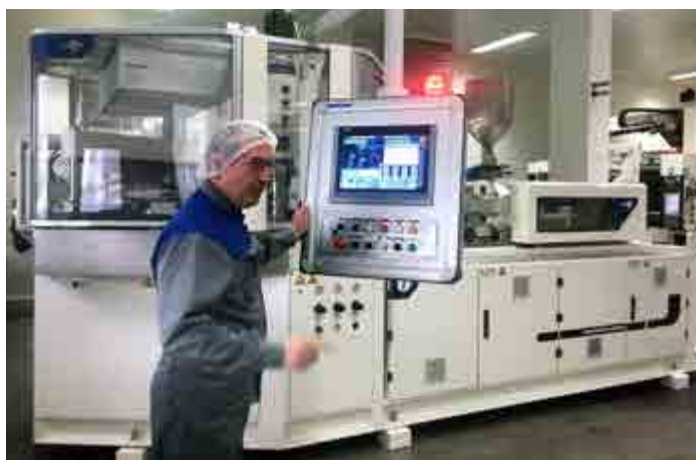
Nouvelle ligne d'injection par soufflage à Union Plastic. Crédits photo : Union Plastic
